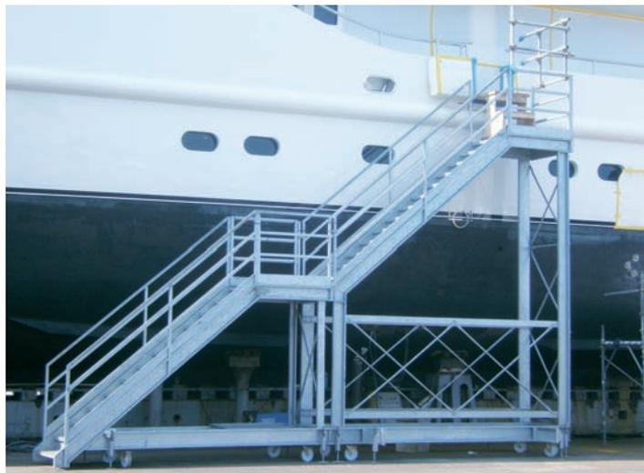
Le rampe delle scale sono realizzate con delle lamiere a "C" pressopiegate a freddo prodotte dalla BFTM con acciai strutturali o con profili normalizzati tipo UPN che tramite il loro accoppiamento permettono di fissare il gradino al loro interno. The stair's flights are realized by "C" cold pressed and bended steel produced by B.F.T.M. using structural iron steel or by normalized UNP profiles that allow through their conjugation to fix the step inside them.
