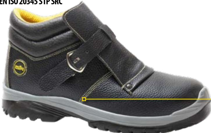
Calzatura alta specifica per saldatori in pelle fiore stampata, copri soffietto (elastico e non lacci) para scorie, chiusura con fibbia a sfilamento rapido. Cuciture in fibra aramidica che determinano una maggior resistenza della scarpa ma soprattutto una protezione dalle scintille della saldatura. Suola in PU bidensità.
